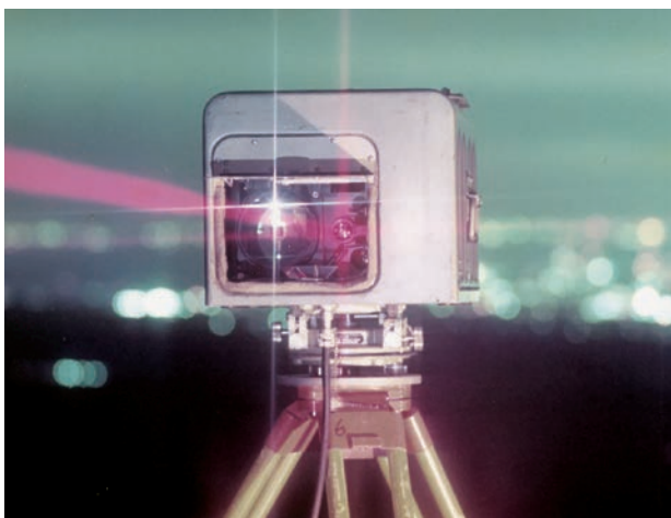
図-4 光波測距儀 (AGA社ジオジメーター 8型)
