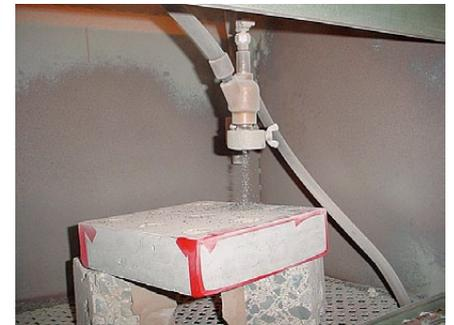
写真-2 耐磨耗試験(ASTM C418)
