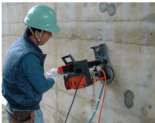
写真1 小径コアの採取状況
