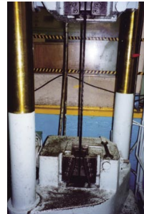
ストランドの引張試験
