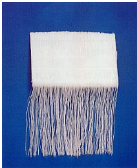
下半はテフロンの基布を剥脱したストランドのみの写真
