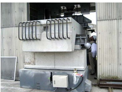
(1) 端部部材の曲げ载荷試験
