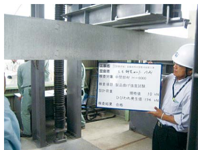
(2) 中間部材の曲げ载荷試験
