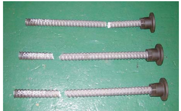
引張試験後の状況 D51 (SD490)
