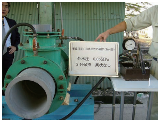
写真-3 本管と取付け管との接合部 水密性試験状況
