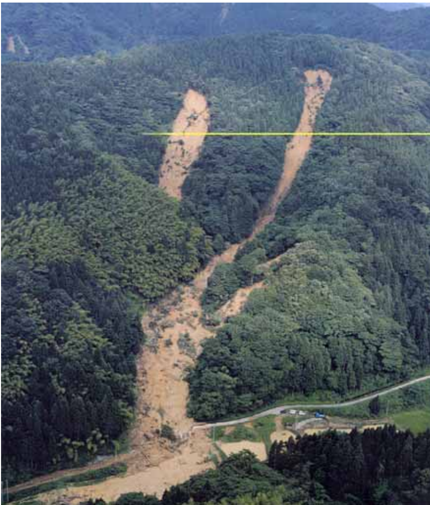
Fig. 9. スプーン型崩壊の例（出雲崎町, Fig. 7 の 、中日本航空（株）提供）
