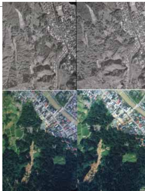
Fig. 21 栃尾市宝光院裏の崩壊 (Fig. 7 右の ) の垂直実体写真。上: 崩壊前(1975) 下: 崩壊後(2004)
