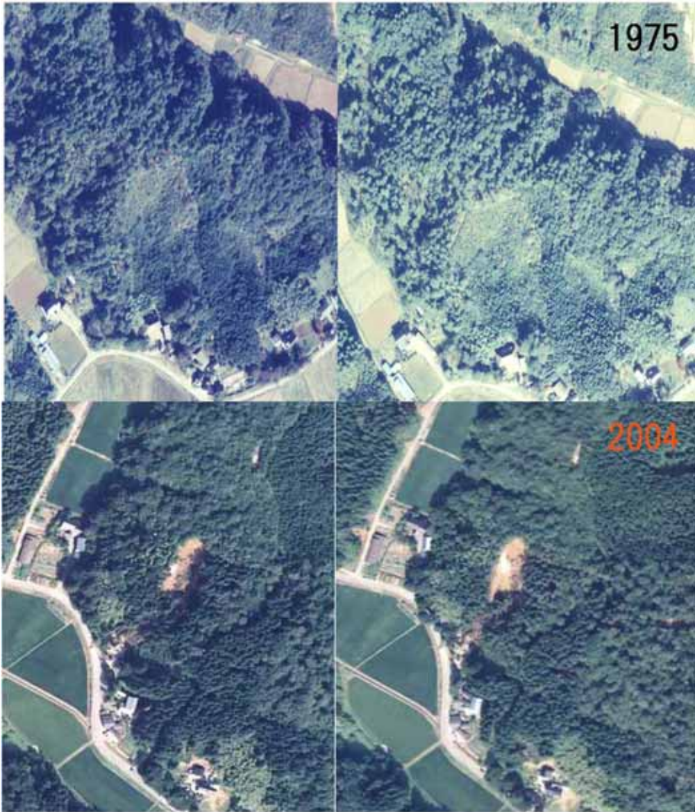
Fig. 19. 出雲崎町中山地区の崩壊地周辺の崩壊前(1975)と崩壊後(2004)垂直実体写真の比較(Fig. 17の ).
