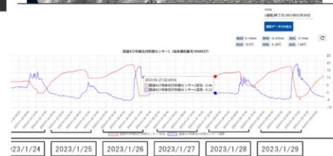
図5 国道沿いI市付近のり面の亀裂計測
