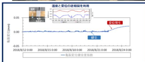
図4 大阪府H跨道橋橋桁の亀裂変位計測
