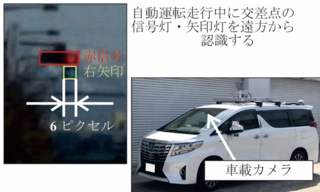
図 自動運転自動車による信号機・矢印灯の認識
