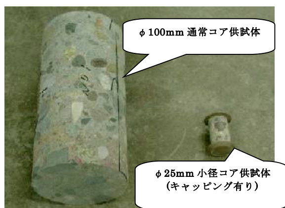
写真2 採取コア供試体の状況
