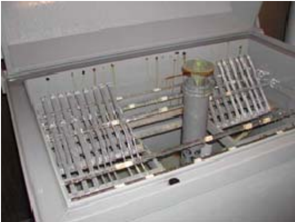
塩水噴霧試験状況
