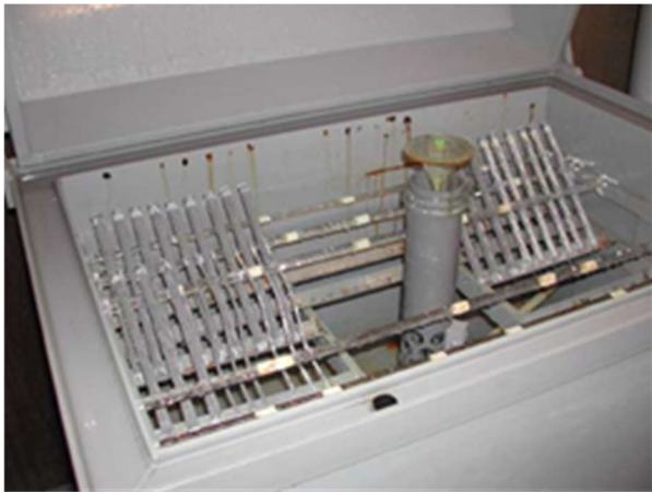
塩水噴霧試験状況
