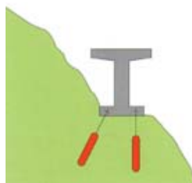
橋脚の転倒防止
