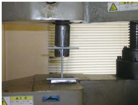
溶接点せん断試験状況
