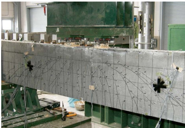
写真-5 静的せん断載荷試験の状況
