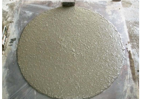
写真-1 高強度繊維補強モルタル
