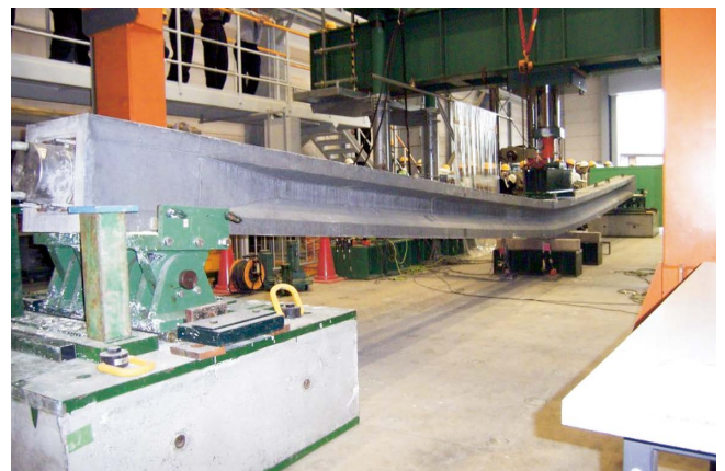
写真-4 静的曲げ載荷試験の状況
