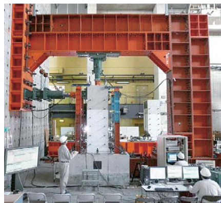
曲げ破壊するRC壁の交番载荷実験
