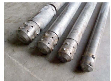
図-7 目粗し処理に用いる目粗しビット（削孔径に応じた目粗しビットを使用）
