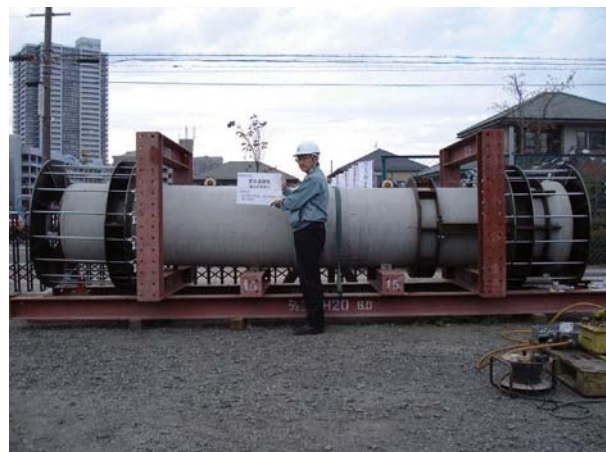
写真－4 既設管への変位追従性試験
