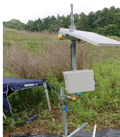
写真-4.1 設置端末の例（30W太陽光パネルや120Whの鉛蓄電池）
