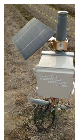
写真-4.3 2W 太陽光パネルと 3Wh のリチウムバッテリーにより小型化を実現
