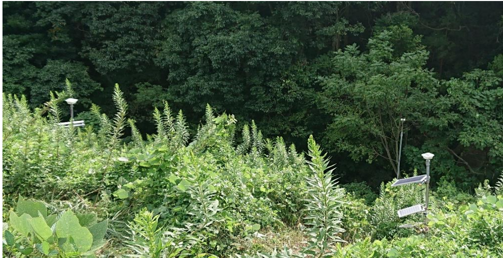
写真-4.2 10m 程度の範囲に設置されたデバイス群（斜面地の例）
