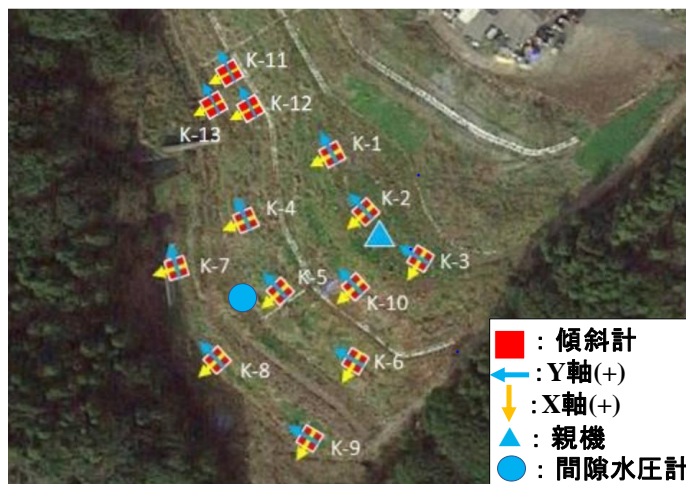
図-2.5 変状検知センサの配置
