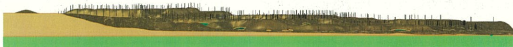
(c) 地質境界面モデルより三次元表示区域を切り出して完成した三次元地盤図
