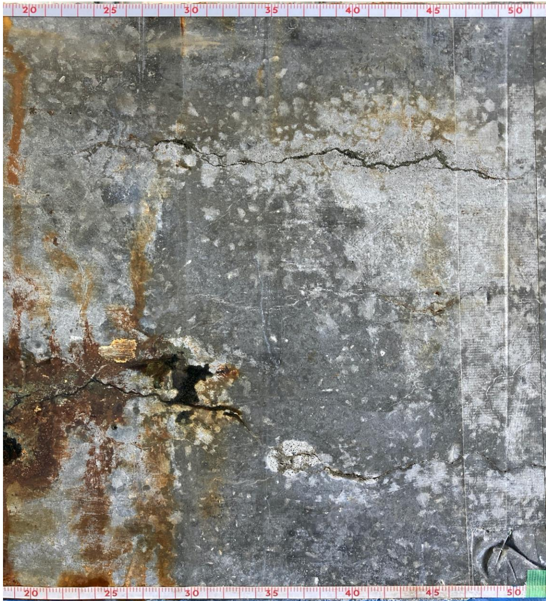
写真 4-5 近接で撮影された腐食ひび割れ画像例（供試体 C3：電食終了後）
