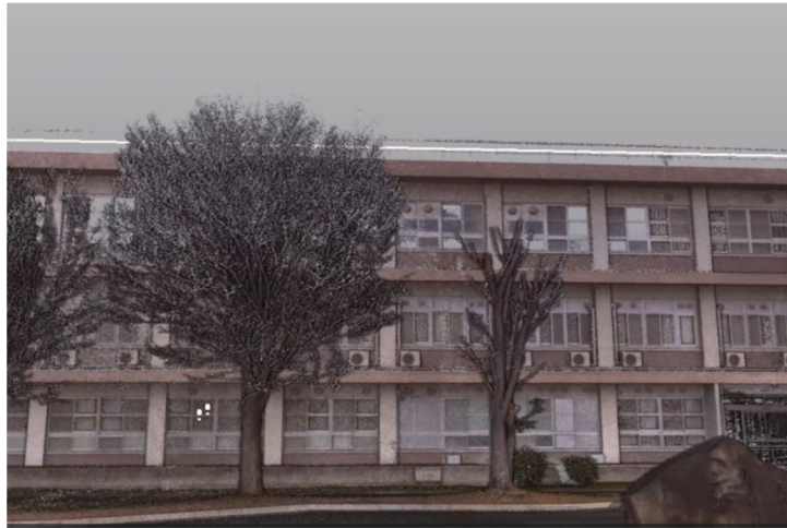
図-4 3D レーザースキャナによる点群データの例
