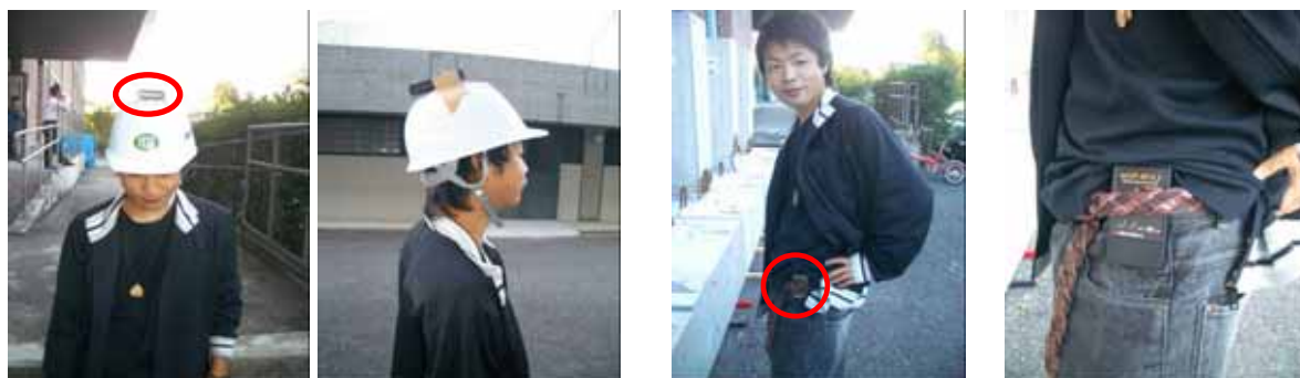
写真 3-7 頭部に G センサーを取り付けた場合 写真 3-8 腰に G センサーを取り付けた場合
