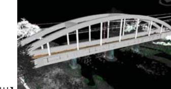
【齊内川】現地3D測量を行い、新設橋りょうのモデルを重ね合わせ
