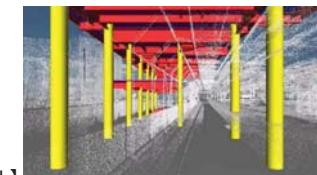
【横浜駅西口ビル】運転土目線による新設駅ビルを重ね合わせた図を作成
