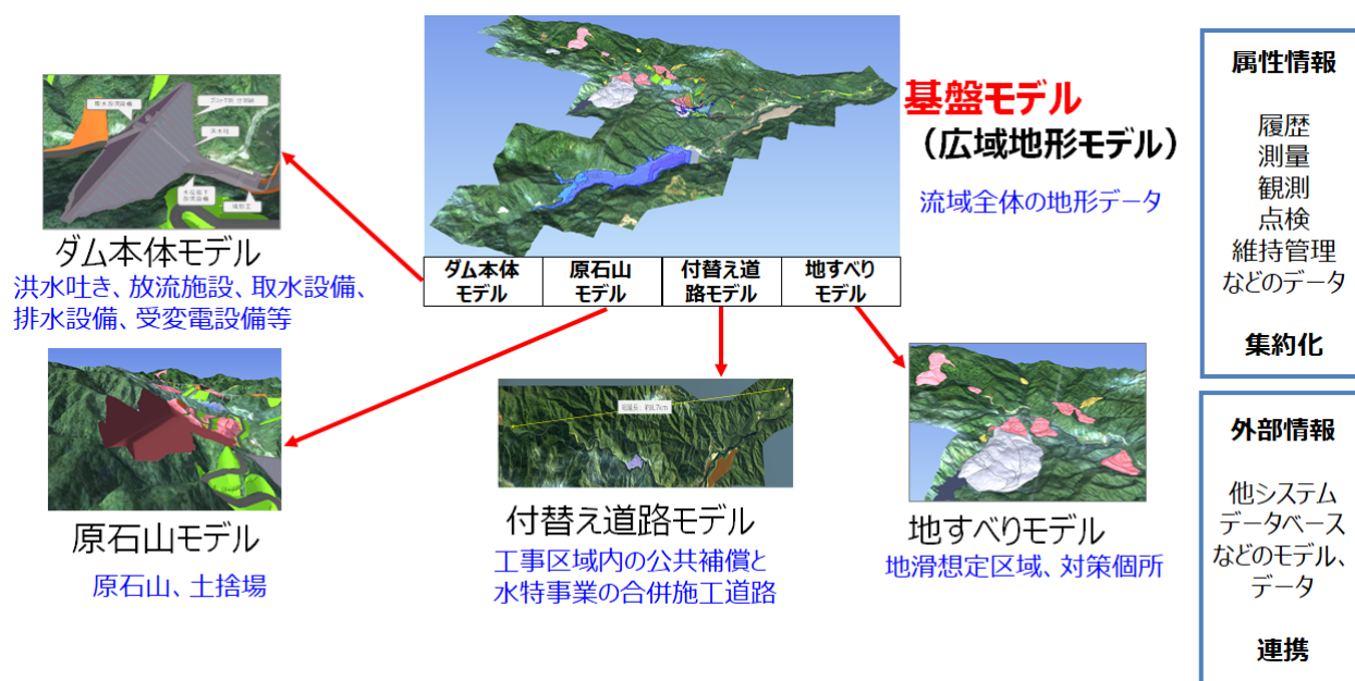
図-4 3次元管内図（統合モデル）の例
