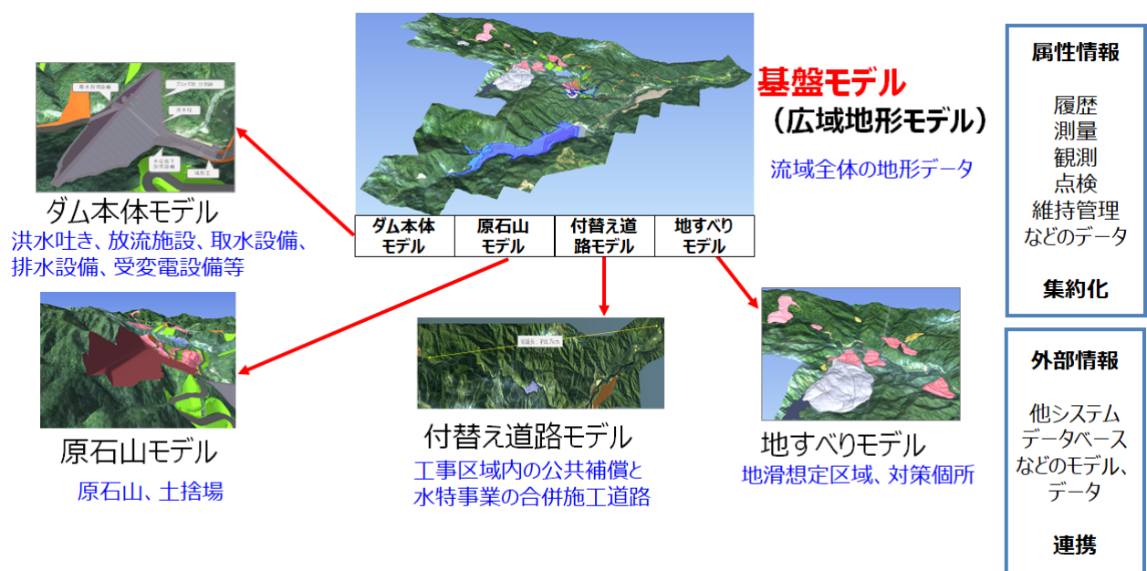
図－4 3次元管内図（統合モデル）の例
