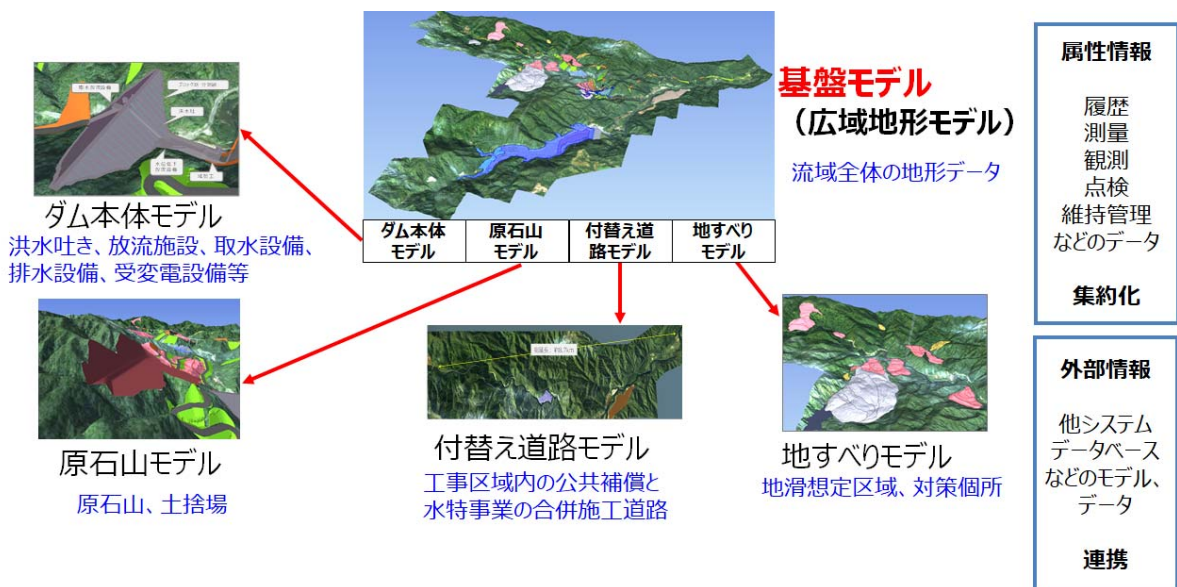
図-7 3次元管内図（統合モデル）の例
