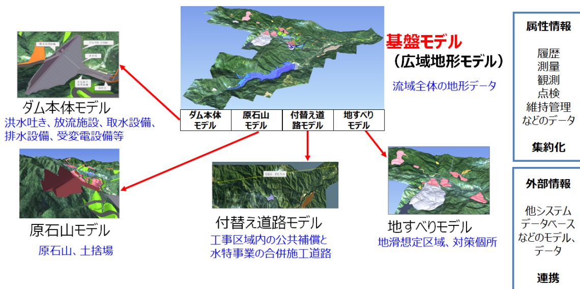
図-11 3次元管内図（統合モデル）の例
