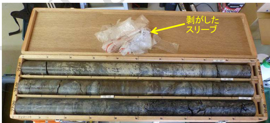
写真 10-7 スリーブを剥がした状態
