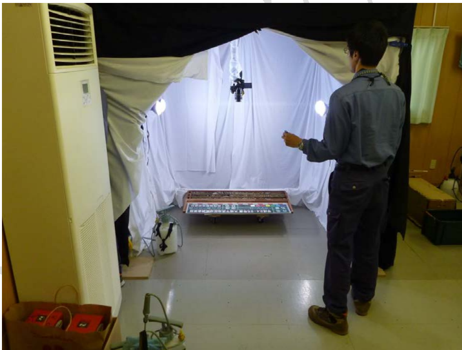
写真 8-2 ボーリングコア写真撮影方法（カメラスタンドタイプ）の例
