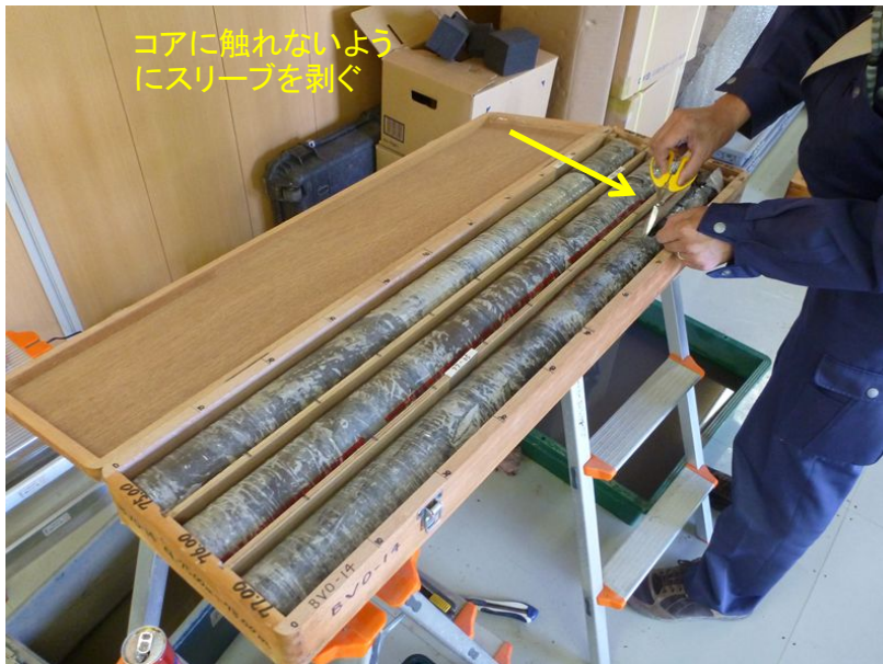
写真 10-6 はさみを使ったスリーブの剥ぎ取り
