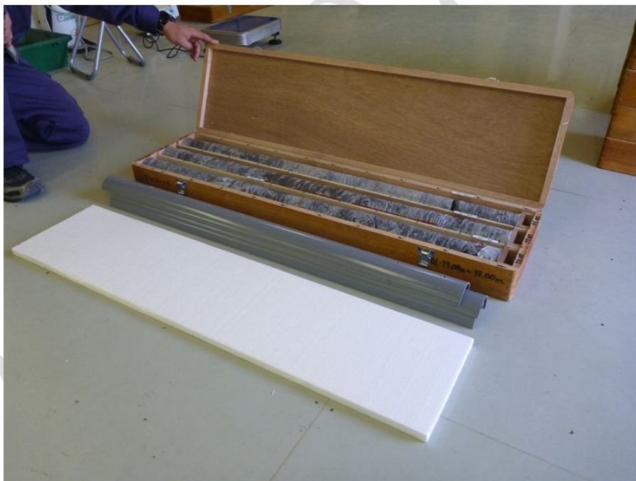
写真 10-14 保護材を取り外した状態
