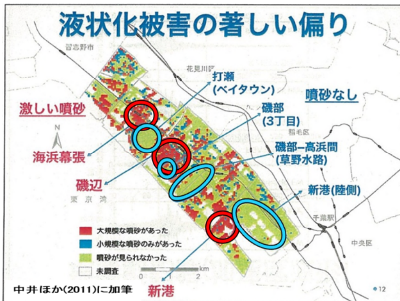
図 2.7.2.9 千葉市美浜区の液状化調査結果 (噴砂の状況/打瀬地区は液状化対策済み)
