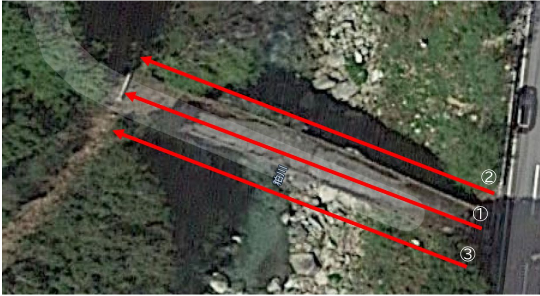
図-31 旧落合橋における UAV の飛行経路
