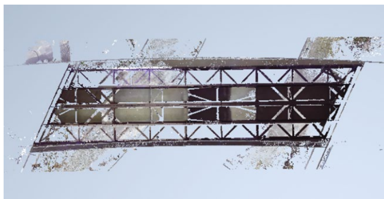
図-25 新前川橋の点群データ (下面)
