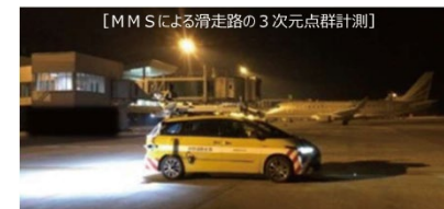
[MMSによる滑走路の3次元点群計測]
