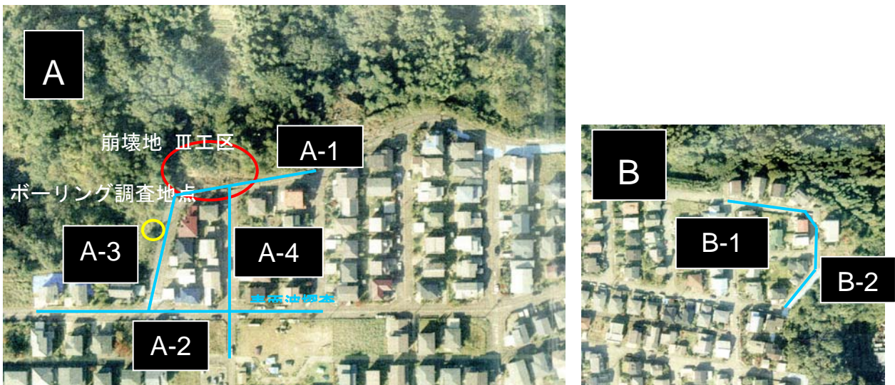
図 2.3.2 表面波探査試験 (A, B 測線)
