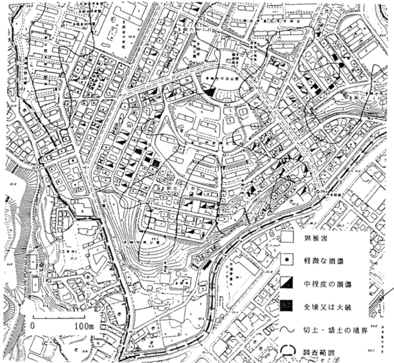
図 14 神戸市垂水区 A 団地における地形改変と建物被害分布 基図は 1/2,500 神戸市都市計画図。 新旧 1/2.5 万地形図から切盛境界線を推定。 現地調査は, 村山, 増田, 川口, 福井による。 村山他(1995)による(福井作図を一部改変)。
