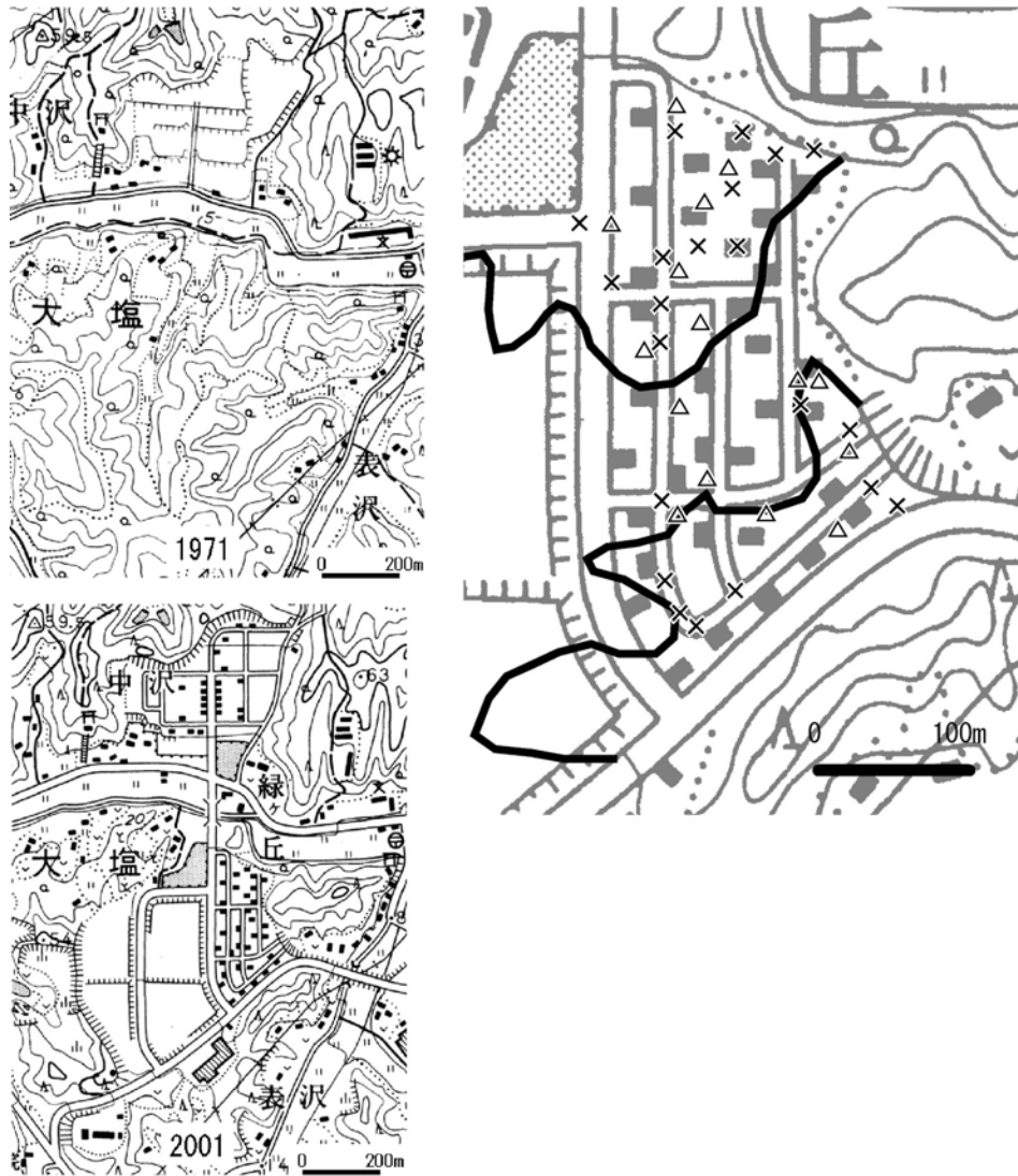
図 21 旧矢本町大塩地区における地形改変と宮城県北部の地震による被害
