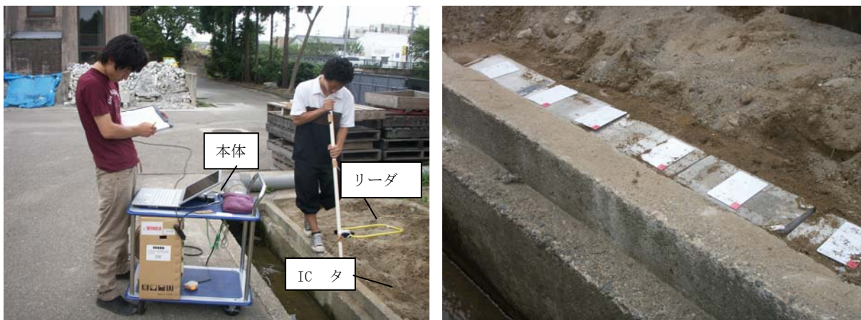
図 5.19 土壌に埋めた IC タグを読み取る実験の様子
