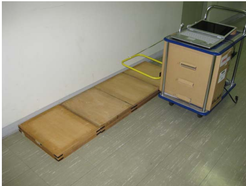
図 5.17 木板の下の IC タグを読み取る実験
