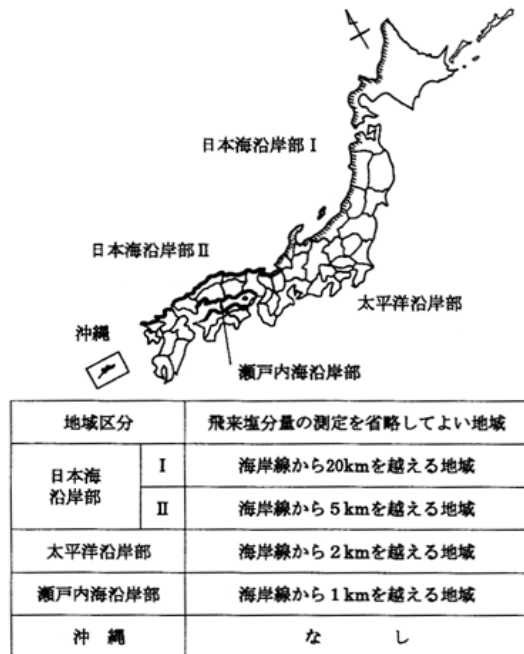
図 2-2 道路示方書で規定された耐候性鋼材を無塗装で使用する場合の適用地域（日本道路協会，2002）耐候性鋼材 JIS-SMA は，飛来塩分量が 0.05 \text{ mdd} (\text{mg}/\text{dm}^2/\text{day}) を超えない地域，あるいは図示した地域で無塗装で用いることができる。
