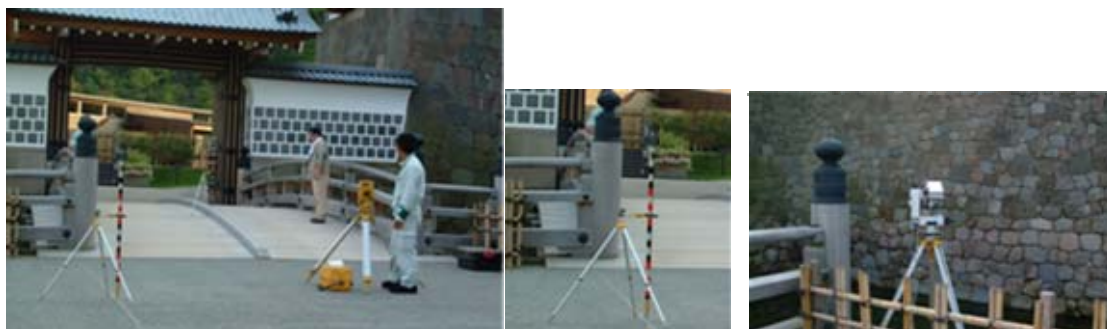
写真-4.6 3次元レーザースキャナーと基準点ターゲットの設置
