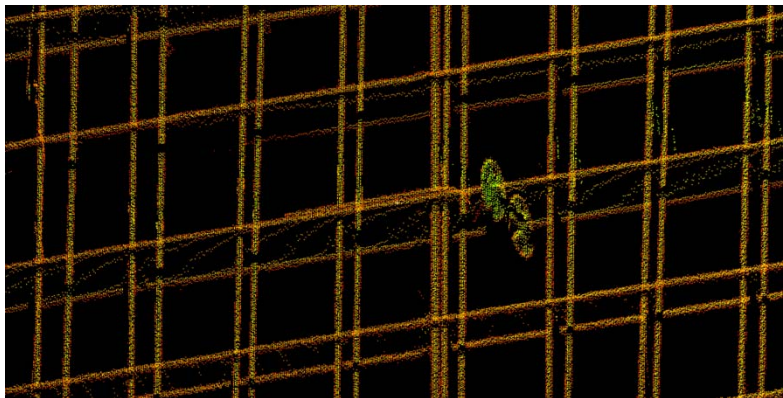
図. 2. 3. 17 重ね継ぎ手の点群
