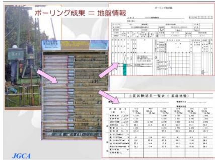
観察・計測結果であるボーリング柱状図と土質試験結果 (kuniJibanよりダウンロード)
