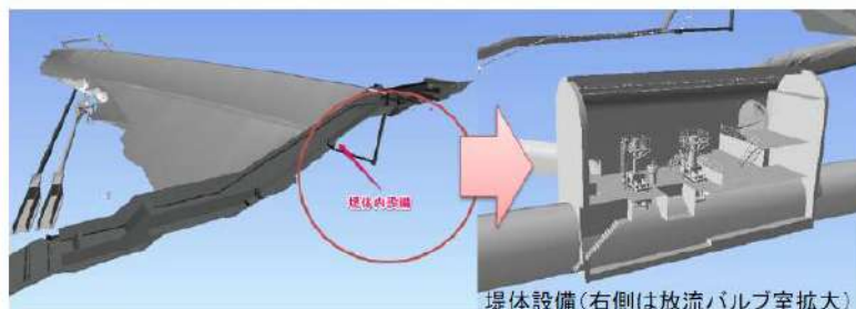
堤体設備(右側は放流バルブ室拡大)
