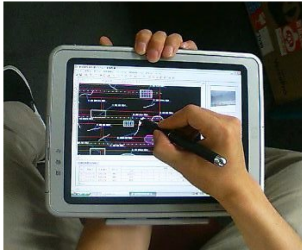
図-4.3 タブレット PC を用いた変状入力
