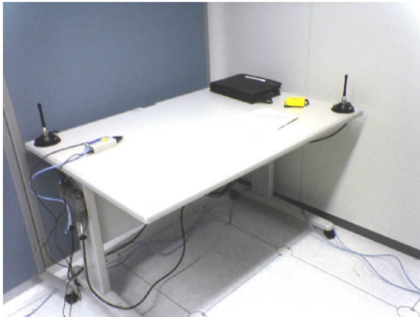
写真 3-1 RFID System 設置状況
