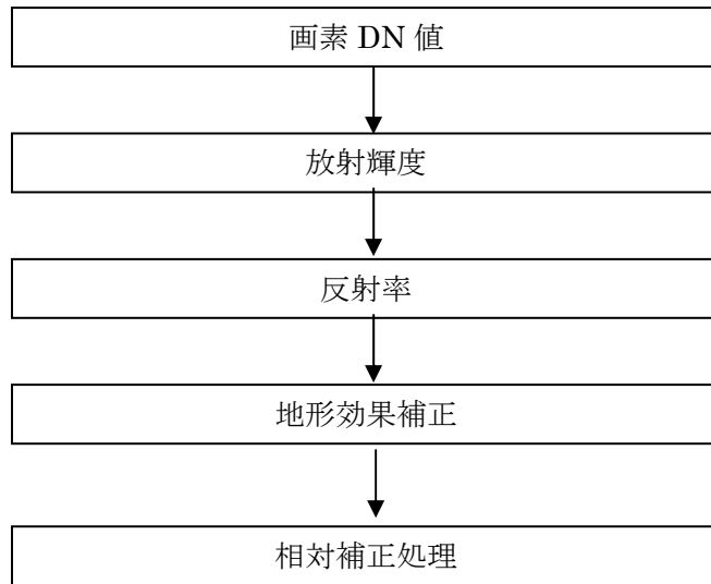
図 3.2 衛星生データから地上反射率への変換手順
