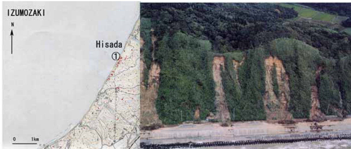
Fig. 8. 平滑型表層崩壊、和島海岸、中日本航空（株）提供。）
