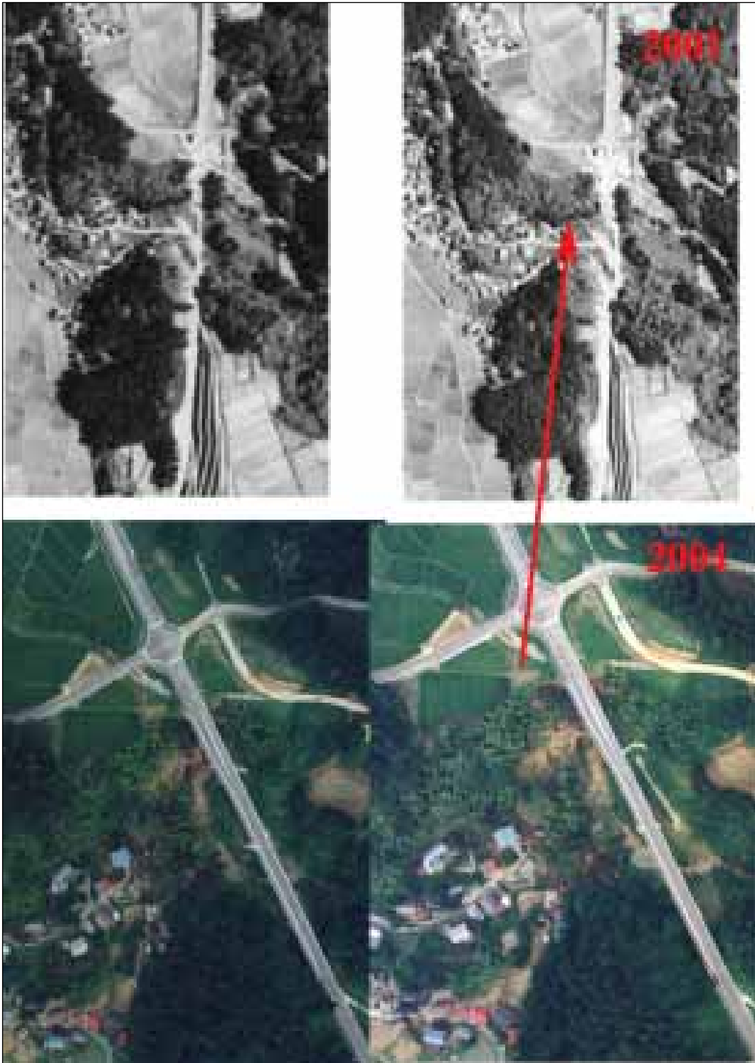
Fig. 12. 栃尾市平地区の発生地すべりの実体写真。上：発生前の 2001 年の空中写真。下：発生直後の空中写真。
