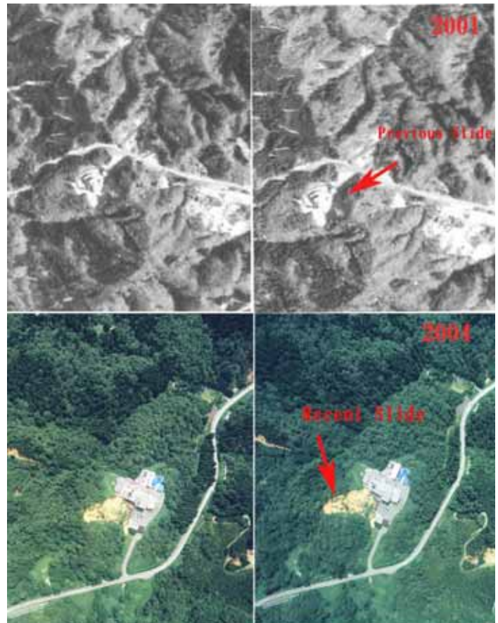
Fig. 16 見附町清掃センター裏の地すべりの発生前(上;2001)と発生後(下)の垂直空中写真。
