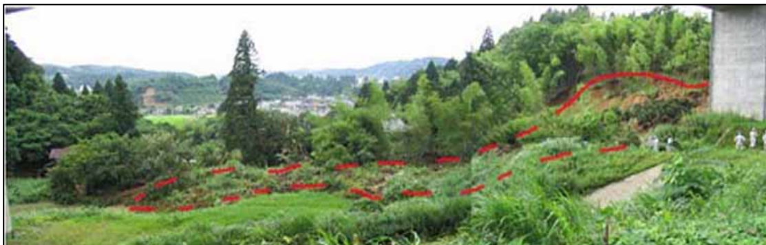
Fig. 11 アースフロー型地すべり（栃尾市平地区）。末端付近の杉の木が立ったまま移動した。
