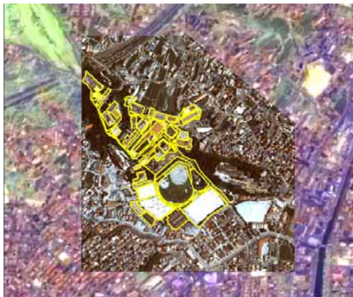
図6 多段階リモートセンシングによるデジタルマッピング画像 (パンシャープン衛星画像、オルソ補正航空写真、測量CAD)
