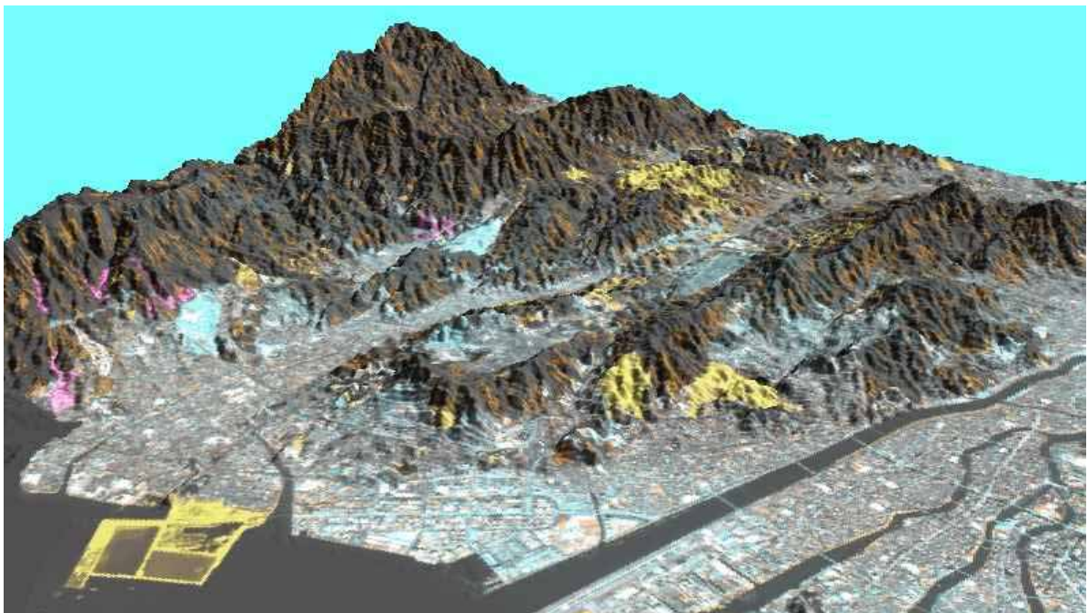
図 2 3 斜面崩壊危険度推定・被災地検出・土地被覆変化の 3 次元合成画像
