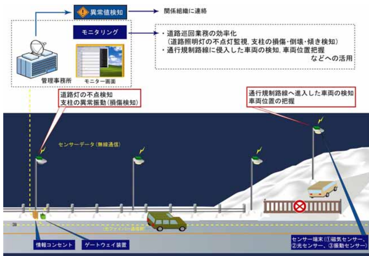
図-5.2 道路施設の維持・管理に無線センサネットワークシステムを導入した場合のイメージ
