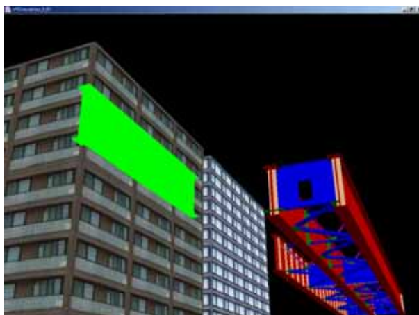
図 - 1 6 VR を用いた干渉チェックアプリケーションの例 (干渉あり)
