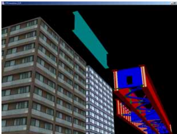
図 - 1 5 VR を用いた干渉チェックアプリケーションの例 (干渉なし)
