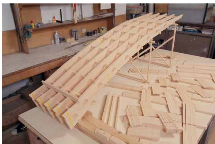
写真6 仮組(手前は加工済み部材)
