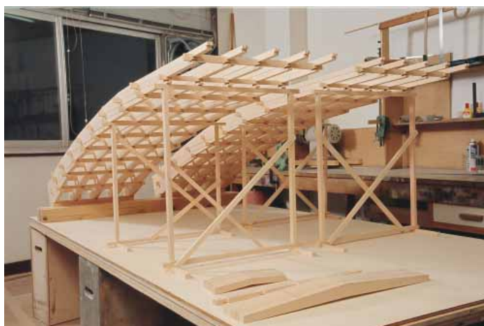
写真7 仮組(手前は大棟木)
